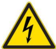
Pericolo elettricità W012
