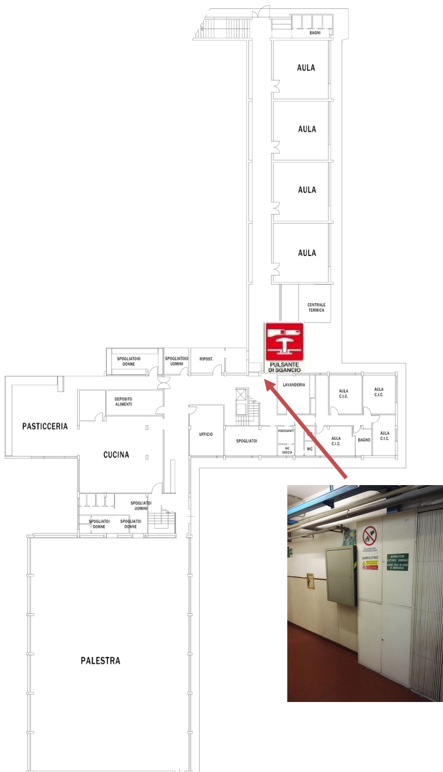
indicazione della posizione del pulsante di sgancio elettrico al piano seminterrato
