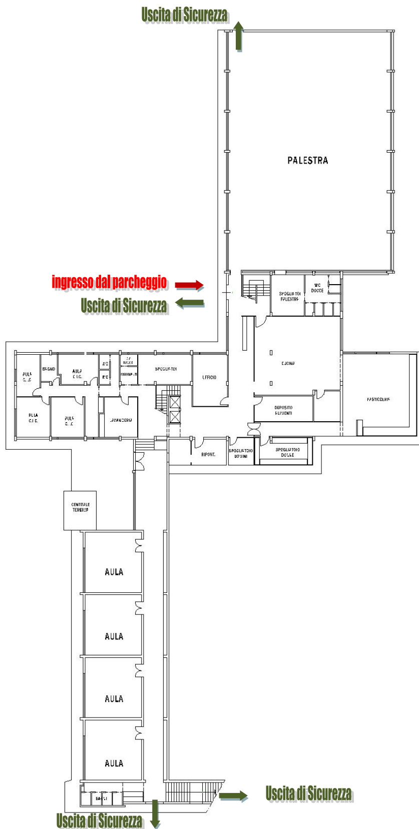
Schema planimetrico del piano seminterrato con indicazione degli accessi e delle uscite di sicurezza
