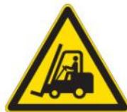
Pericolo carrelli elevatori ed altri veicoli industriali W014
