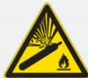
Pericolo bombola pressurizzata W029
