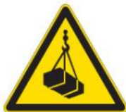
Pericolo carichi sospesi W015
