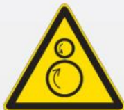
Attenzione rulli rotanti/ pericolo di trascinamento W025
